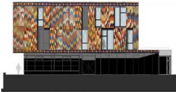
Fassade Südseite, variable Verschattungsstufen
