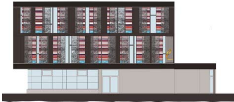
Fassade mit frei verschiebbaren Verschattungselementen, Südseite
